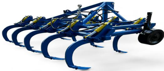
CH-P è un nuovo tipo di tiller idropneumatico E' un coltivatore idropneumatico adatto per lo scasso e la lavorazione di terreni vasti. Il telaio è molto rinforzato grazie all'ottimo progetto degli elementi che lo costituiscono. I corpi di lavoro sono disposti in modo tale da eliminare gli ingolfamenti da residui colturali. Durante la prova in campo le ancore sono riuscite a rompere e lavorare il terreno con un'unica passata, lasciando il suolo ben livellato.
